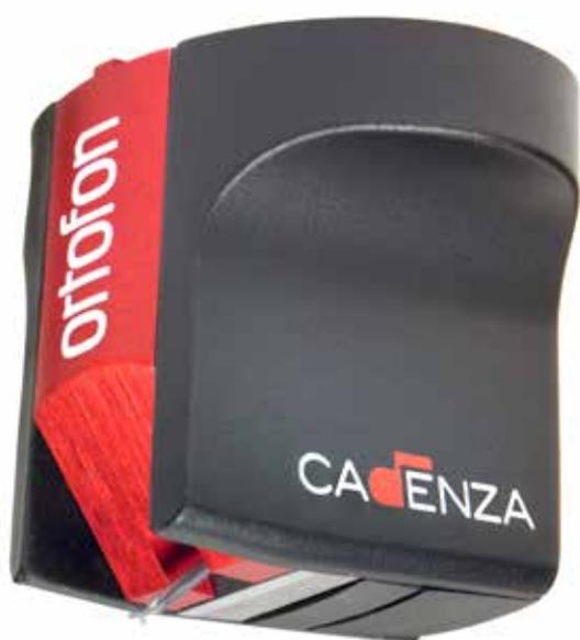
L'image sonore de la Cadenza Red est détendue, homogène et modérément dynamique, offrant beaucoup d'espace et de profondeur dans l'image stéréo. Le modèle Cadenza Red utilise une aiguille Nude Fine Line avec une flèche cylindrique en aluminium. Le rayon de la pointe de l'aiguille est de  $r/R$  8/40  $\mu\text{m}$ . Les bobines sont en fil d'argent pur 6NX (99,9999 %). Un processus d'enroulement amélioré au niveau de l'ancre permet un meilleur équilibre des canaux.
